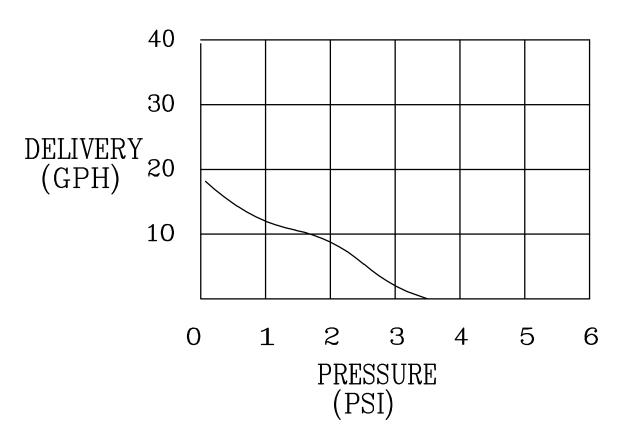
MINIMUM PRESSURE VS. DELIVERY CURVE AT NOMINAL VOLTAGE. ZERO HEAD ON FUEL INLET AND OUTLET. FUEL — COMMERCIAL GASOLINE
